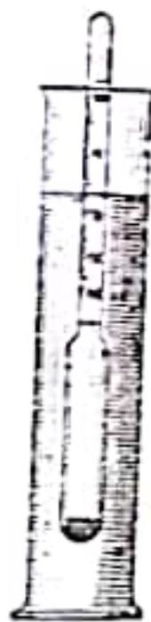
الشكل (1-2) مقياس الوزن النوعي
